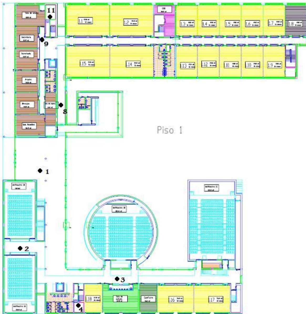
Figura 0.6- Local amostragem valores de iluminância no piso 1 edifício VII.
