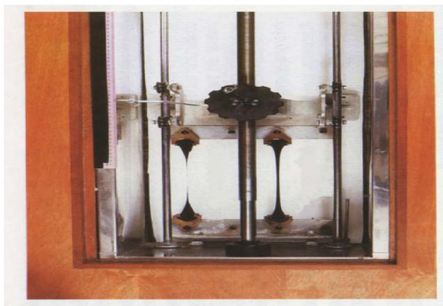
Figura 6.19 – Pormenor de um ensaio de ductilidade em betumes
