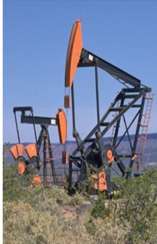
Figura. 4.10 – Exemplo de bomba tipo “cavalo de madeira”
