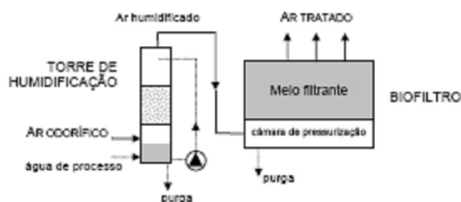
Figura 2.6 - Diagrama simplificado de uma linha de tratamento de ar odorífico por biofiltração, adaptado de [Rosa Antunes, 2006].
