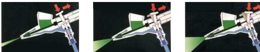
Figura 5.1 - Funcionamento do aerógrafo
