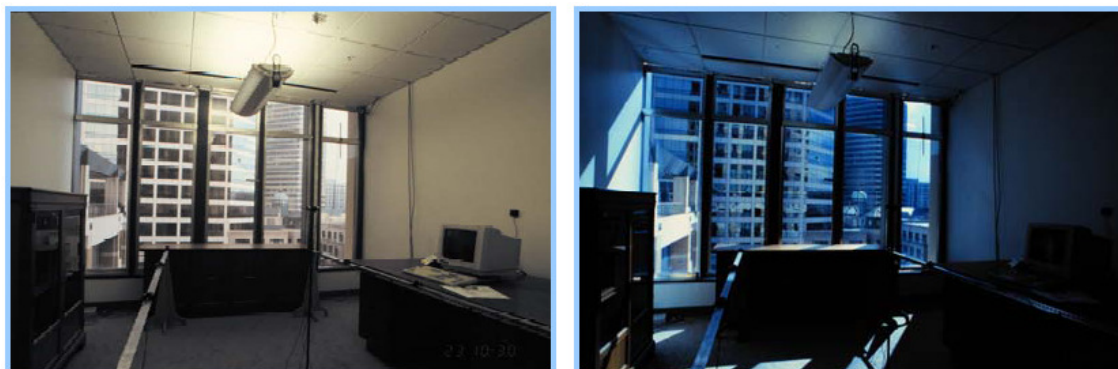
Figura 2-8- Variação da transmitância numa janela electrocrómica exterior [14]
