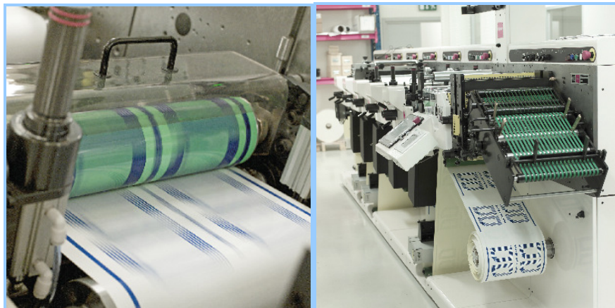
Figura 2-3- Impressão do papel electrocrómico (Fonte Fotofabriken) [15]
