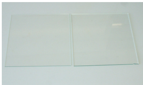
Figura 4-7- Comparação de vidro limpo (à esquerda) com outro vidro com TCO e o electrólito sólido \text{LiAlF}_4 (à direita)
