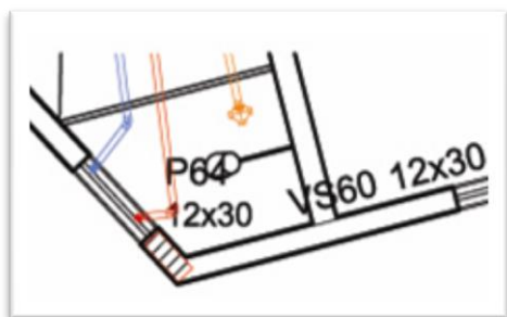
Figura 3.16 – Planta baixa intersecção de tubulações de água fria e água quente com esquadria.
