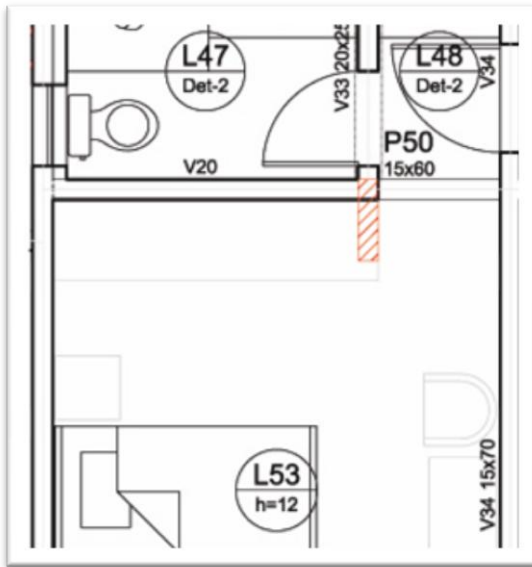
Figura 3.53 - Planta baixa desalinhamento de pilar com parede.
