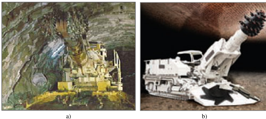
Figura 4.5 – Roçadora: a) de corte transversal (adaptado de Ferrocemento in Bastos, 1998); b) de corte axial (in World Tunneling, 2008).
