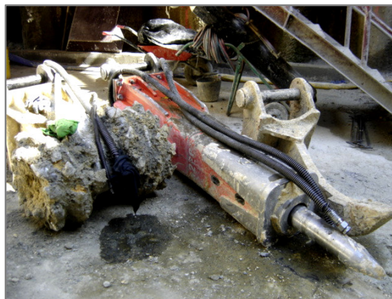
Figura 7.26 – Equipamento de desmonte (roçadora, martelo hidráulico e ripper).
