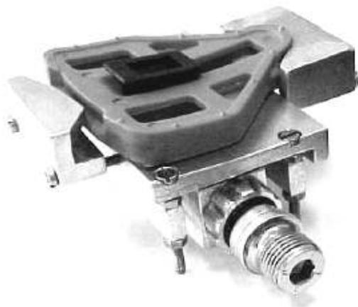
Figura 3: Pedal instrumentado (direito), cedido especialmente pelo LAPEX-ESEF-UFRGS.
