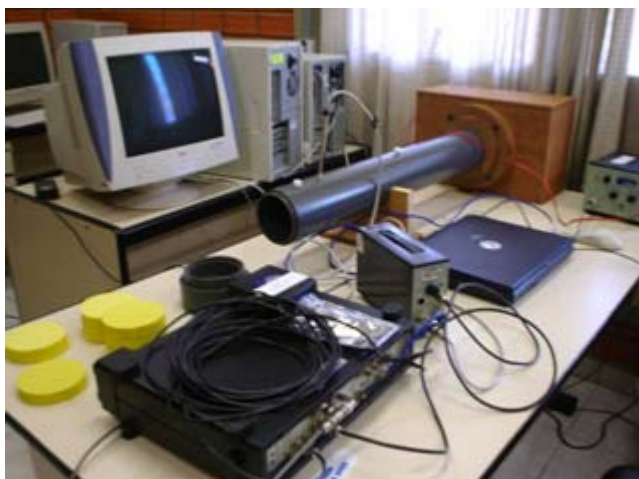
Figura 6.2 – Foto da bancada do tubo de impedância
