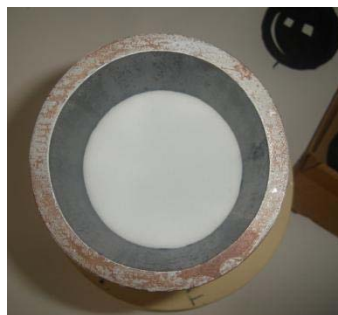
Figura 4.6 – foto da vista de cima do porta-amostra com uma amostra acondicionada sobre a tela de nylon.
