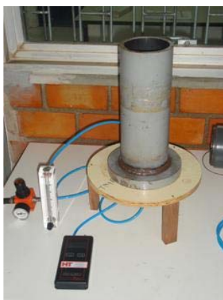
Figura 4.2 – Foto da bancada para medição da resistividade ao fluxo.
