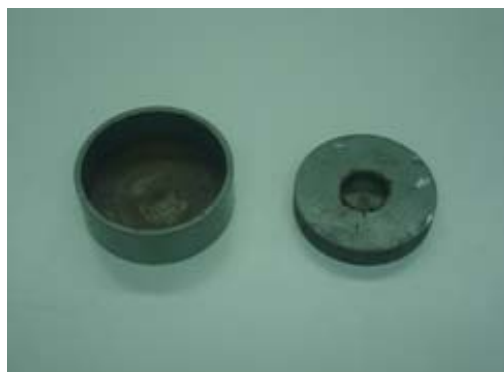
Figura 5.3 – Foto do porta-amostra e do cilindro de compressão
