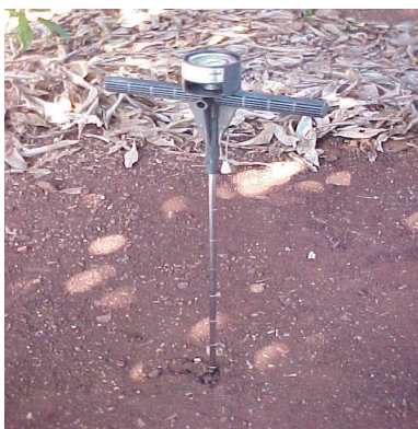
Anexo E: Penetrômetro utilizado para avaliar a resistência a penetração.
