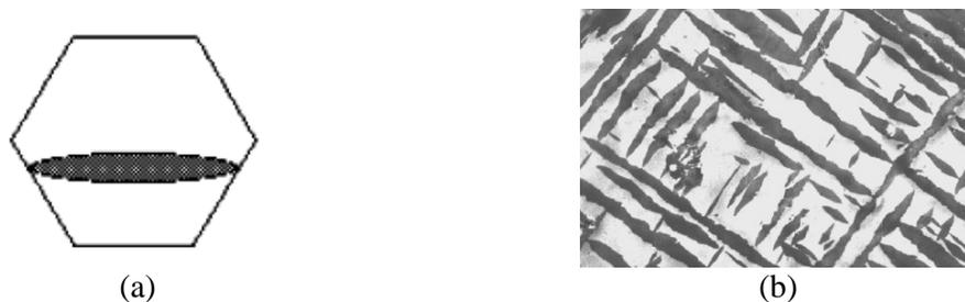
**Figura 2.3.7** – (a) Macla de deformação esquemática (Bhadeshia, 2002) e (b) rede de maclas em uma chapa de aço revestida com zinco (Forest, 2000).
