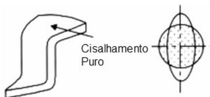
**Figura 2.1.12** – Embutimento ou cisalhamento puro em uma flange de um copo embutido.
