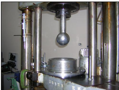
**Figura 3** - Ferramental utilizado para o ensaio de Nakazima.
