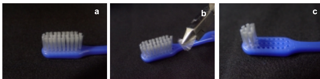
Figura 1 – a) Escova utilizada na escovação dos blocos de esmalte; b) Remoção de parte das cerdas com alicate ortodôntico 139; c) Conformação final da escova.
