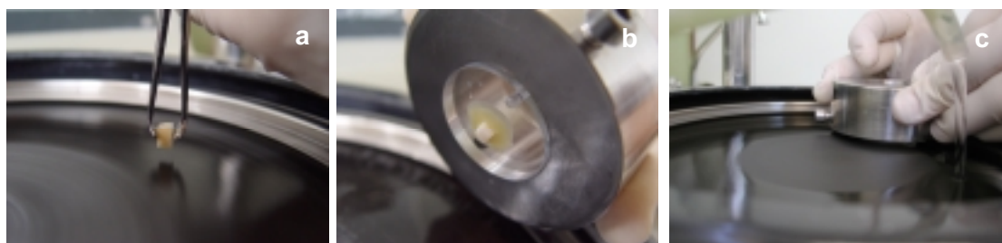
Figura 6 – a) Planificação da dentina; b) Conjunto bloco/base de acrílico e dispositivo metálico; c) Lixamento.
