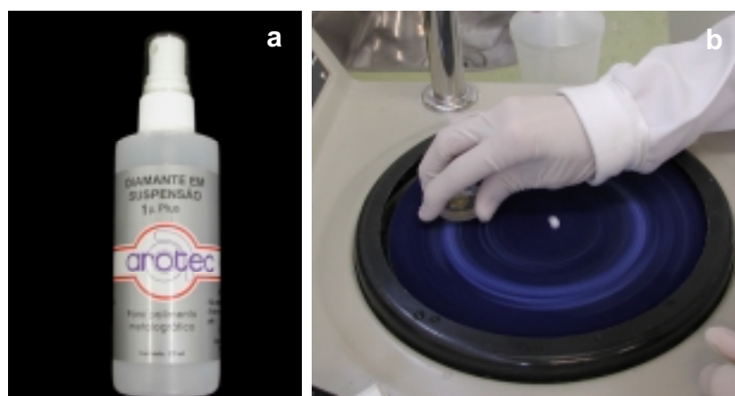
Figura 7 – a) Diamante em suspensão para polimento; b) Polimento do bloco de esmalte.
