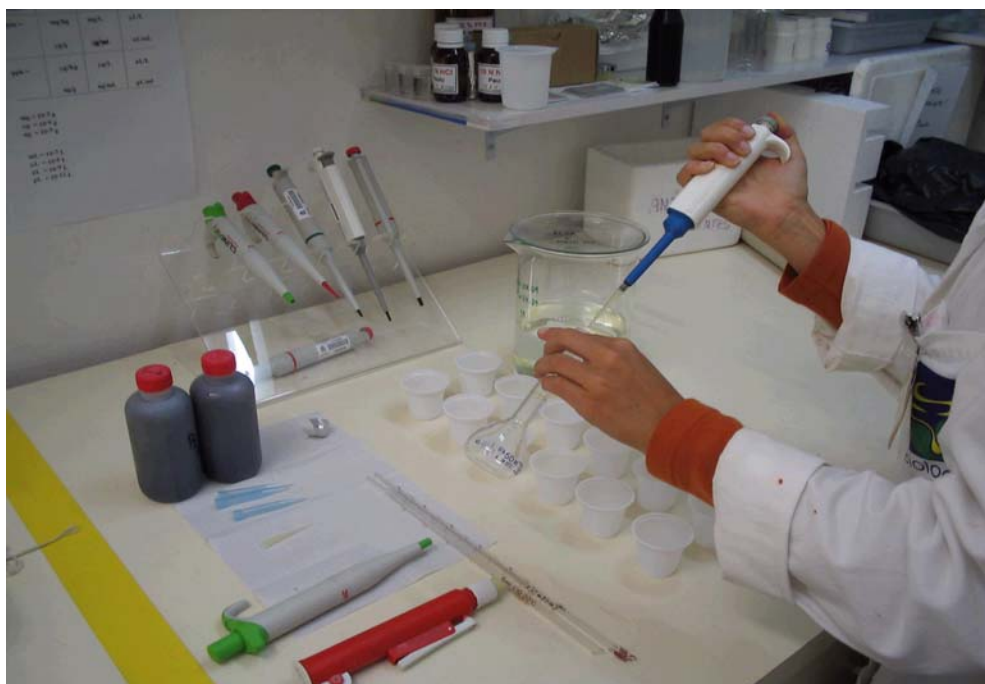
FIGURA 8: Preparação das soluções-teste com precisão volumétrica para um teste agudo.
