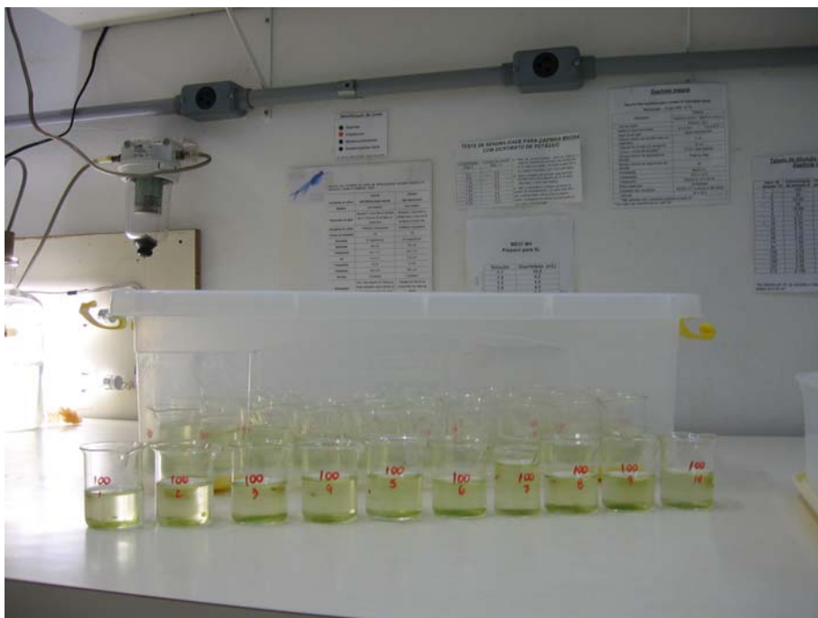
FIGURA 11: As 10 réplicas da solução-teste de 100% em um teste de toxicidade crônica.
