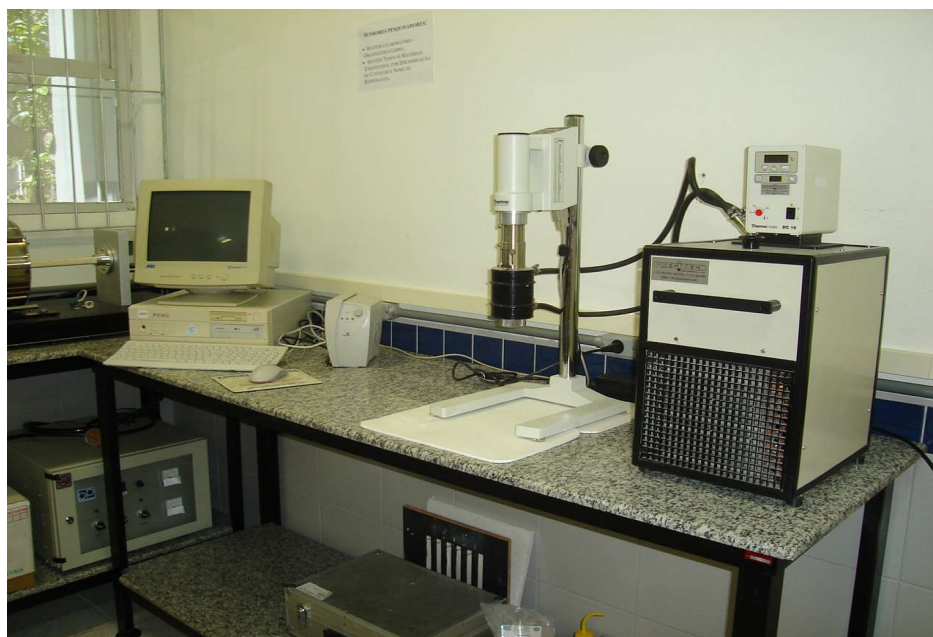
Figura 11 – Reômetro digital com banho termostático e sistema de aquisição de dados
