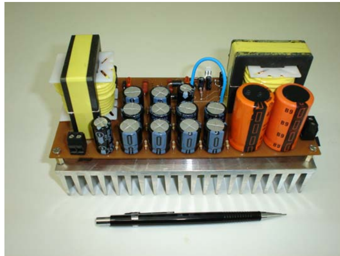
Figura 3.66 – Foto do conversor boost montado em laboratório.
