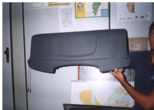
Ilustração 2.8 – Peças automobilísticas produzidas com reforço de fibra de curauá
