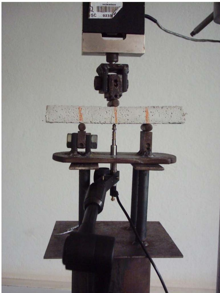
Ilustração 4.14 – Vista geral do aparato de ensaio de tração na flexão
