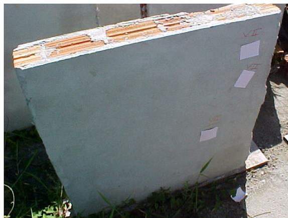
Ilustração 5.29 - Localização e quantidade de fissuras nas argamassas C0,50PET e CR com cerca de 210 dias de idade
