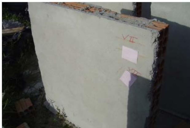
Ilustração 5.27 - Localização e quantidade de fissuras na argamassa CR com cerca de 150 dias de idade
