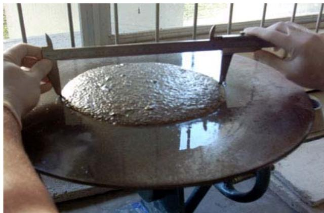
Ilustração 4.5 – Medição do índice de consistência para argamassa de cal referência
