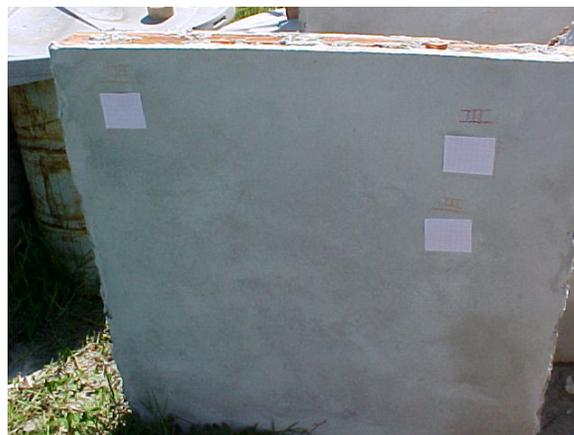
Ilustração 5.28 - Localização e quantidade de fissuras nas argamassas C0,25C e C0,25PET com cerca de 210 dias de idade
