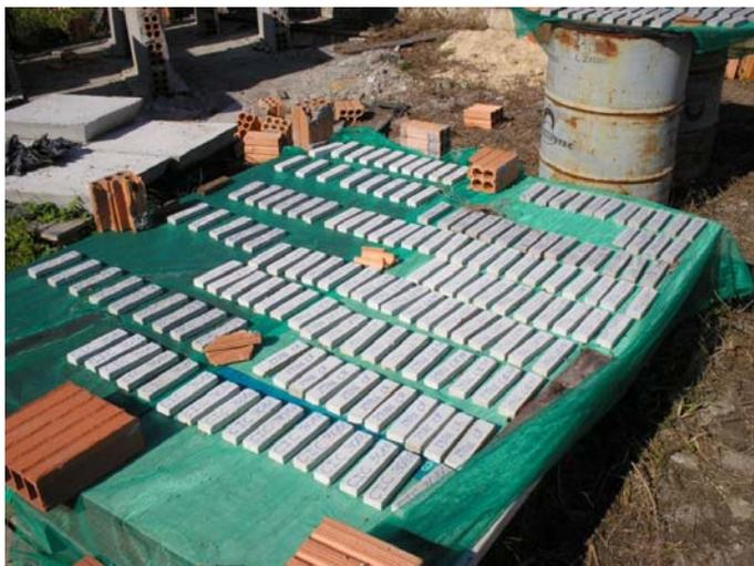
Ilustração 4.13 – Exposição dos corpos de prova prismáticos
