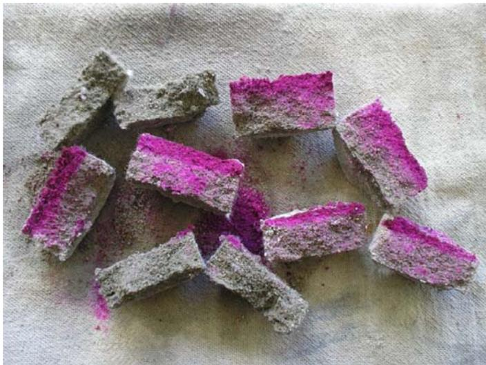
Ilustração 4.11 – Corpos de prova aspergidos com solução de fenolftaleína
