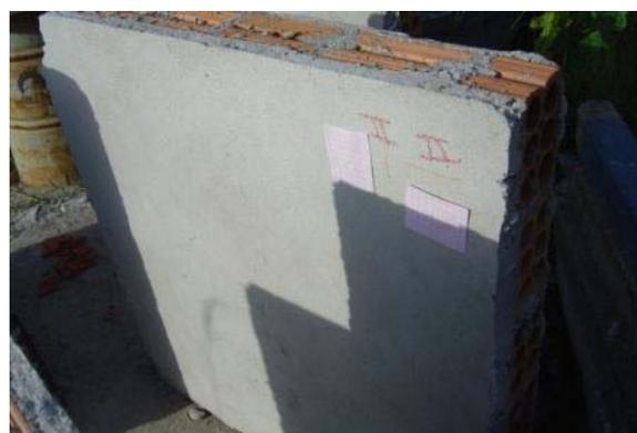
Ilustração 5.25 – Localização e quantidade de fissuras nas argamassas C0,25C e C0,25PP com cerca de 150 dias de idade
