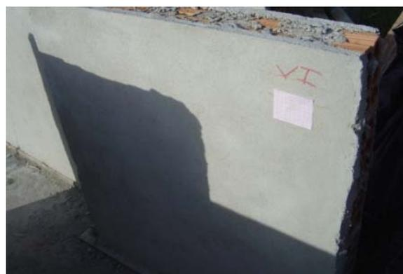
Ilustração 5.26 – Localização e quantidade de fissuras nas argamassas C0,25PET e C0,50C com cerca de 150 dias de idade
