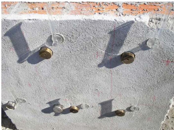
Ilustração 4.10 – Parede instrumentada para a realização de ensaios de aderência e cachimbo
