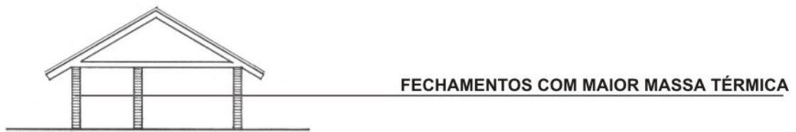
Figura 2.34. Massa térmica para aquecimento.
