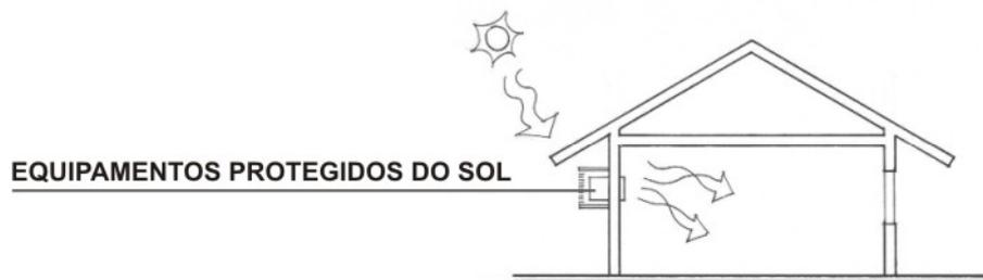
Figura 2.31. Instalação de ar condicionado.
