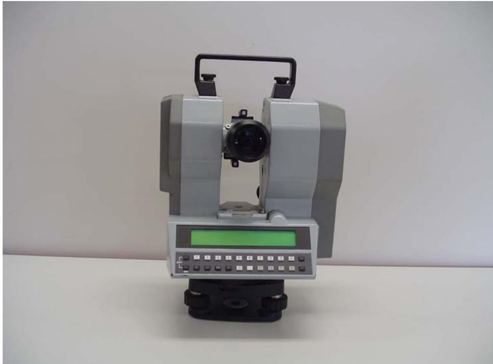
Fig.53 Estação total Zeiss Rec Elta 15C
