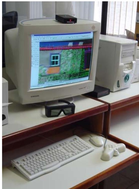
Fig 55 Kit ImageStation SSK, restituidor fotogramétrico
