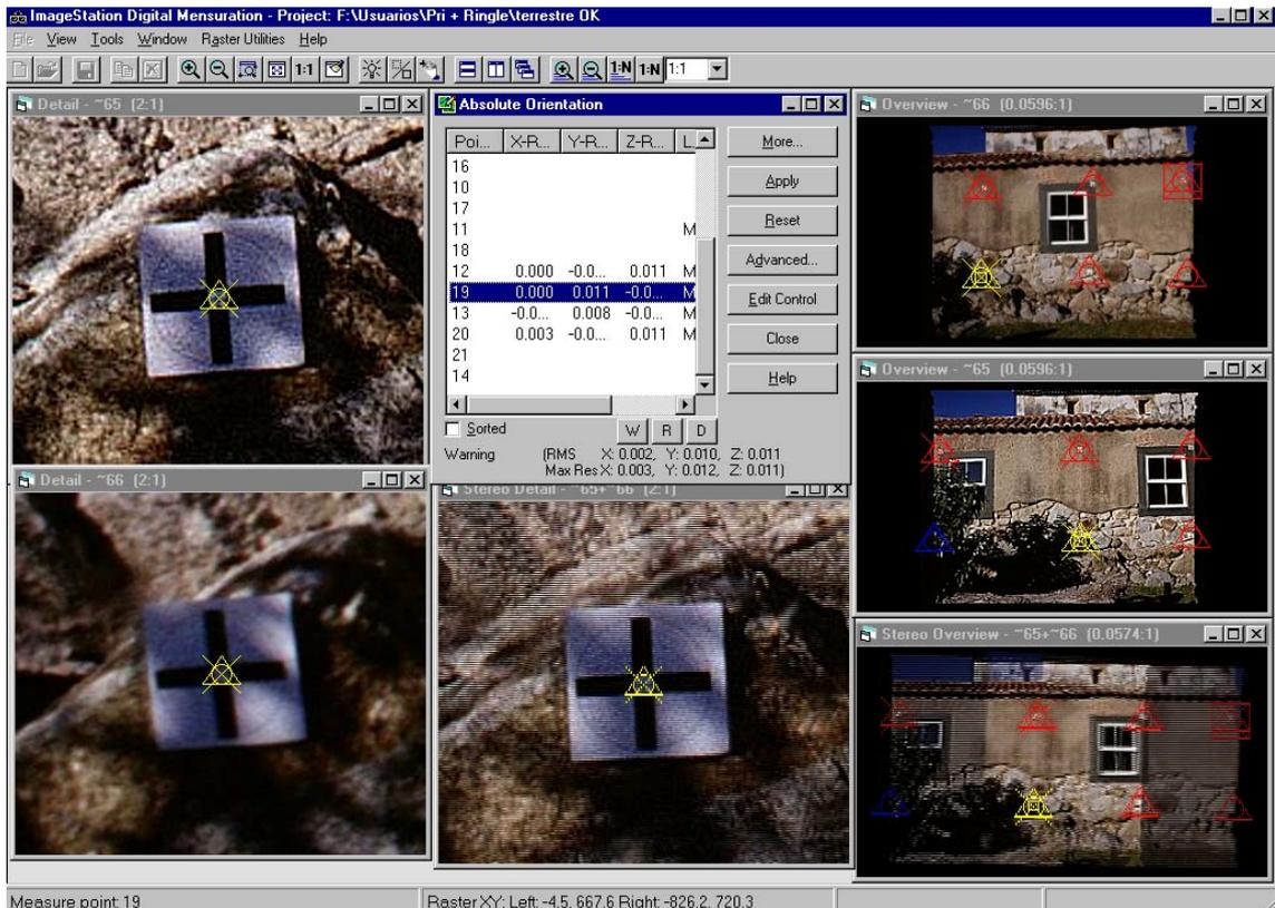
Fig.127- Foto 65 + Foto 66 (orientação absoluta) com seus pontos de controle, detalhes de cada foto e sobreposição das fotos em stereo.
