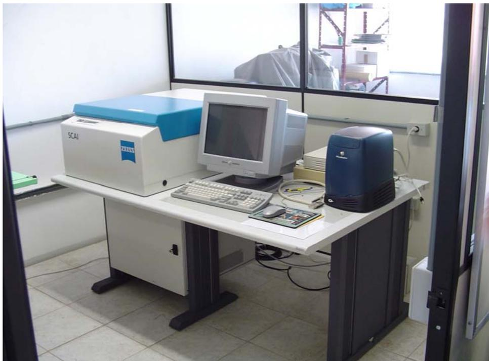
Fig 54 *Scanner de diapositivos SCAI* da empresa ZEISS
