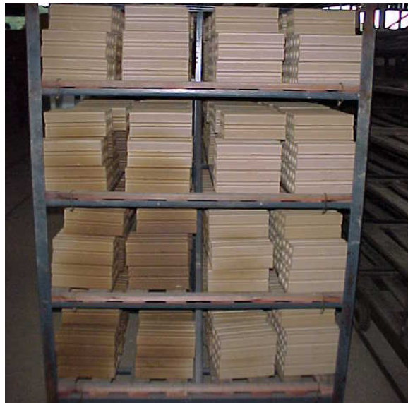
Figura 3.17 – Situação 1: secagem na configuração original.
