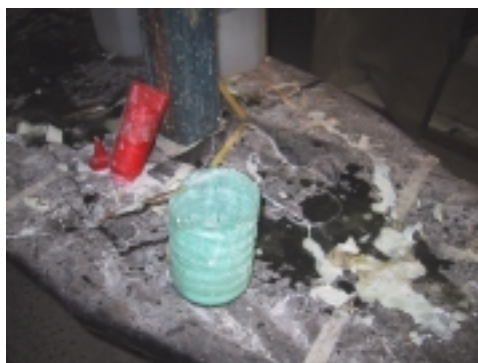
Figura 13: Resíduos Gerados no Processo Fabril das Pranchas de Surfe
