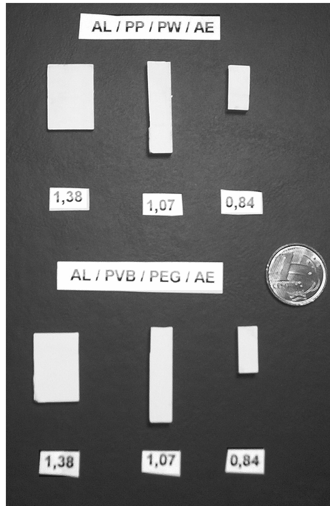
Figura 46. Fotografia das peças de alumina sinterizadas, produzidas por moldagem de pós por injeção a partir dos sistemas em estudo.
