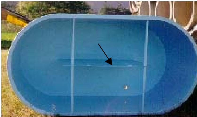
Figura 2. Foto com vista de cima do tanque experimental mostrando divisão central e barras de estrutura e sustentação do tanque.
