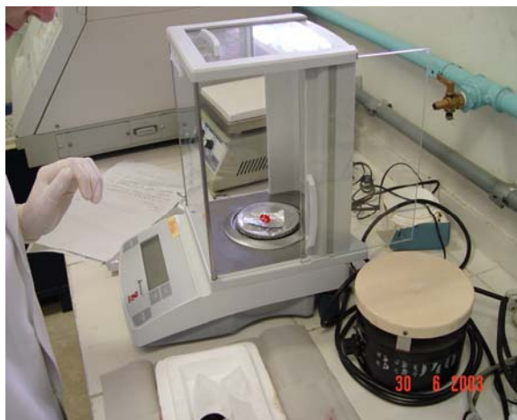
Figura 9 – Pesagem das amostras.
