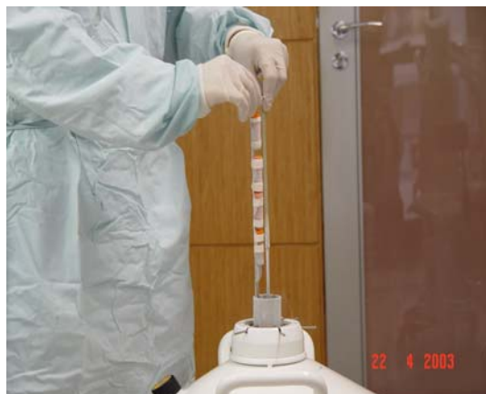
Figura 6 – Imersão das amostras em nitrogênio líquido.
