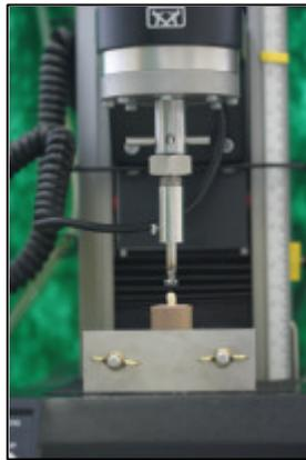
FIGURA 27 – Espécime posicionado na máquina de teste.
