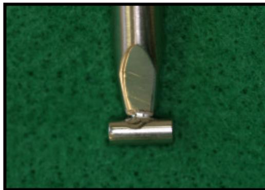
FIGURA 12 – Dispositivo oclusal para o teste de compressão
