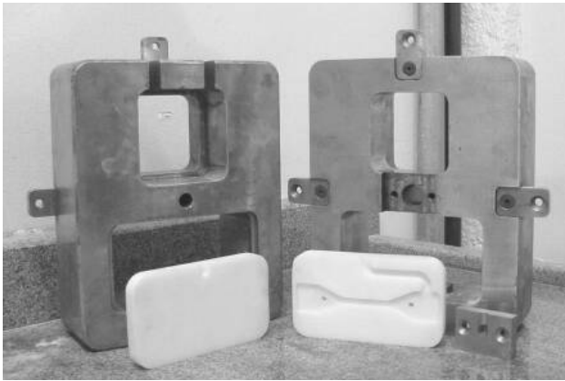
Figura 2.14 a: Insertos em ABS fabricados pelo processo FDM [Ahrens et al (2) 2002].
