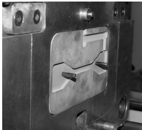
Figura 2.15: Inserto usinado em placa epóxi [Ahrens (2) 2002].
