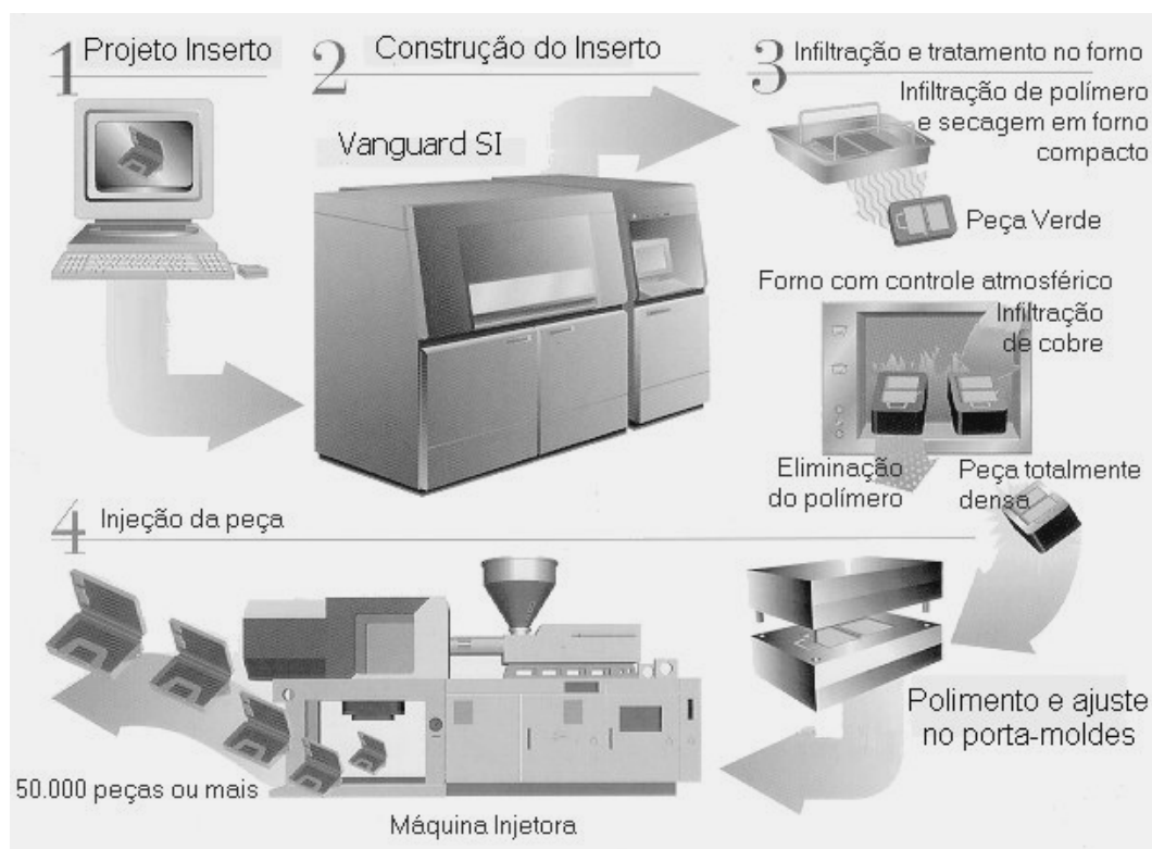
Figura 2.11: Seqüência para a obtenção de uma DRT utilizando o processo SLS [Flag 1996].
