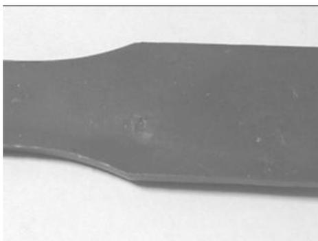
*Figura 6.4 – Detalhe do corpo de prova produzido com a amostra B<sub>0</sub> da FP, evidenciando as impurezas não fundidas na superfície do moldado.*
