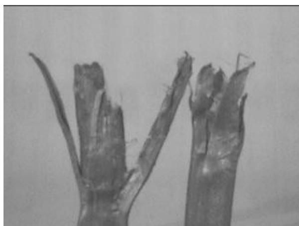
*Figura 7.20 - Fotografia de detalhes do corpo de prova da amostra B5 na região de fratura*
