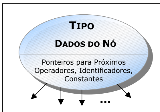
Figura 18: Estrutura de dados de armazenamento de comandos em Português Estruturado
