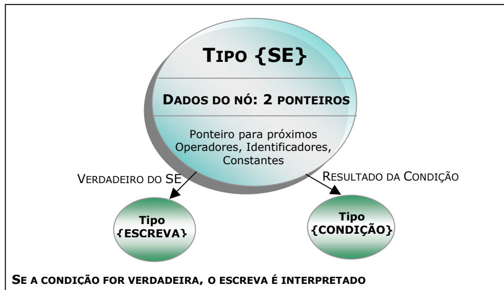
Figura 19: Visão da árvore de Estrutura de Dados e o tratamento do Interpretador
