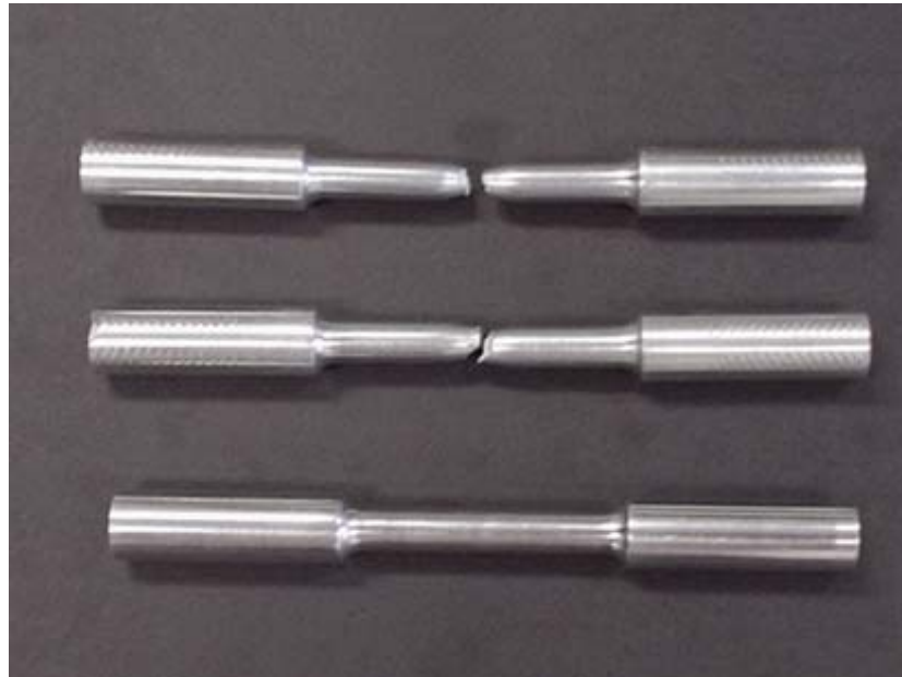
Figura B.5: Corpos de prova cilíndricos de alumínio 6351.
