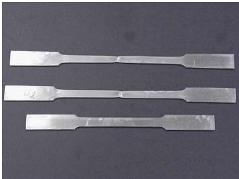
Figura B.2: Corpos de prova retangulares de aço inox 316.
