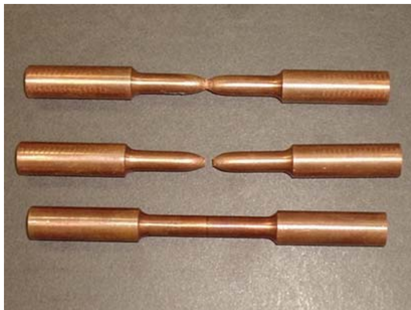
Figura B.6: Corpos de prova cilíndricos de cobre CA110.
