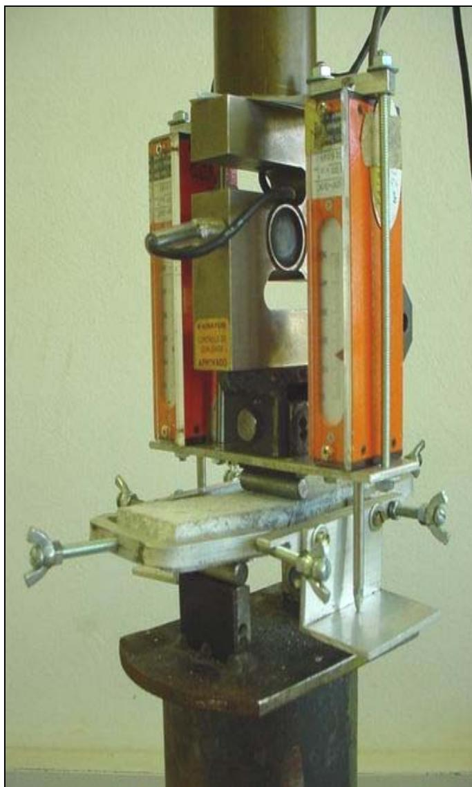
**FIGURA 13** - Ensaio de tração na flexão de corpo-de-prova de argamassa (40x20x160mm)
