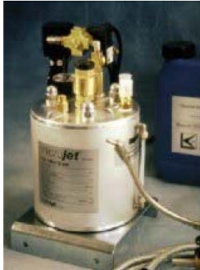
Figura 8.2 – Equipamento para aplicação de MQF por bicos externos
