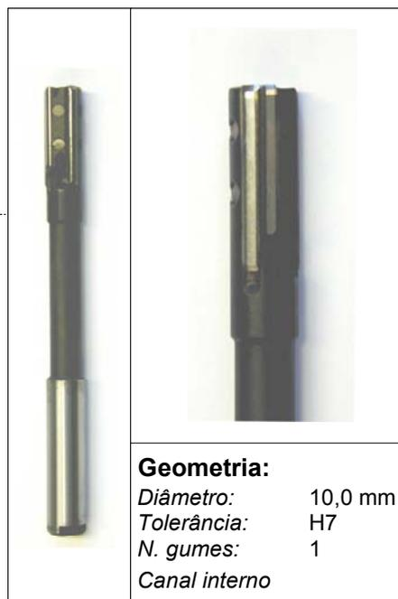
Figura 4. 6 – Alargador testado com MQF aplicado através de furos previstos na ferramenta
