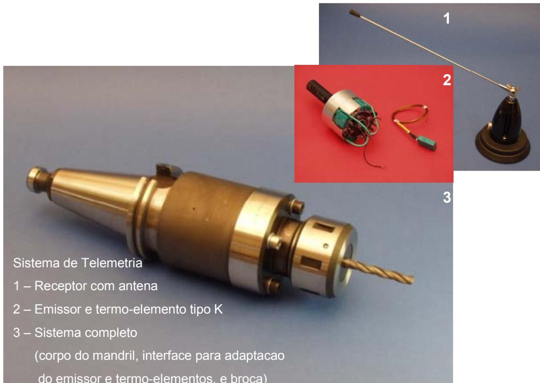
Figura 5. 74 – Principais componentes do Sistema de Telemetria desenvolvido para a medição da temperatura na broca em rotação
