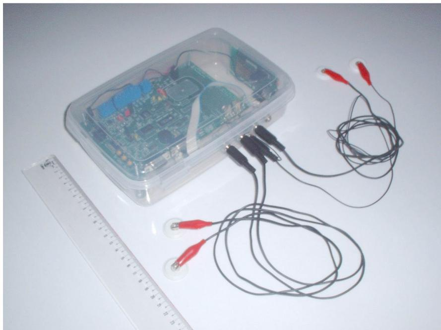
Figura 30 – Foto do protótipo do dispositivo portátil de telemetria.
