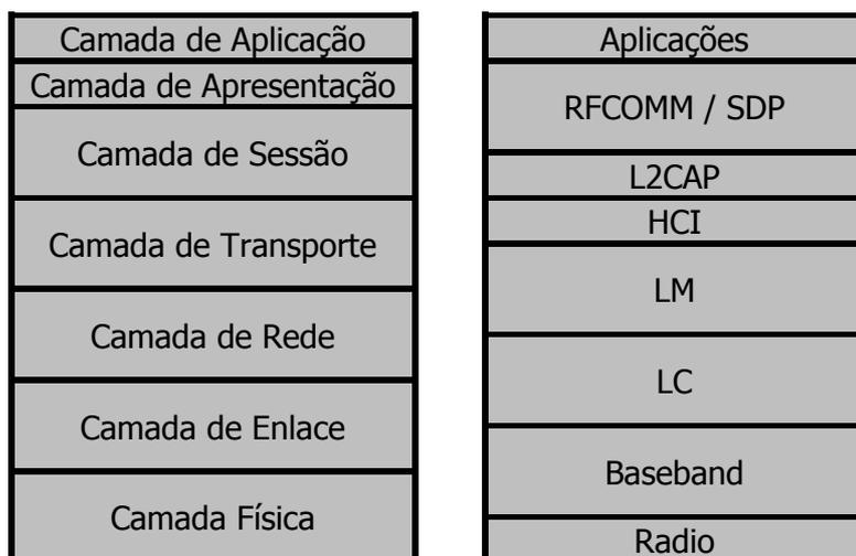
Figura 20 – Comparação entre o modelo OSI e a pilha de protocolos Bluetooth.
