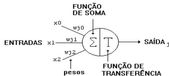
Figura 03: Esquema representativo de um neurônio artificial
