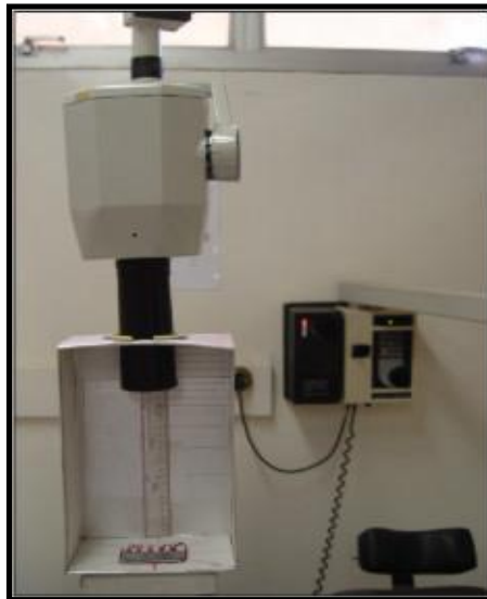
FIGURA 2 - Película posicionada no dispositivo utilizado para padronização das radiografias
