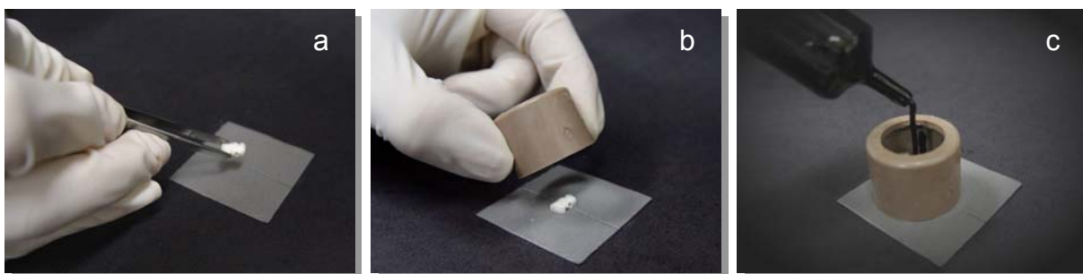
Figura 5. a) Fixação da porção de esmalte em fita dupla face. b) Posicionamento do molde (bucha) de PVC. c) Inclusão da resina de poliéster com o auxílio de uma seringa plástica.
