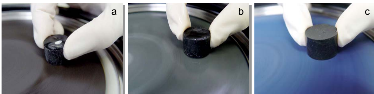
Figura 6. a) Planificação da base com lixa 100. b) Lixamento da superfície do esmalte com lixas de 600 a 2000. c) Polimento da superfície do esmalte com feltro e pasta de alumina.
