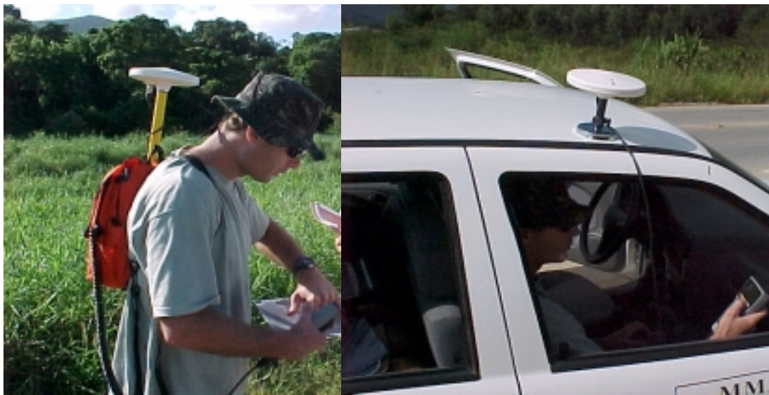
Figura 11. Levantamento com GPS (Stop And Go E Cinemático) na bacia do Rio Inferninho.
