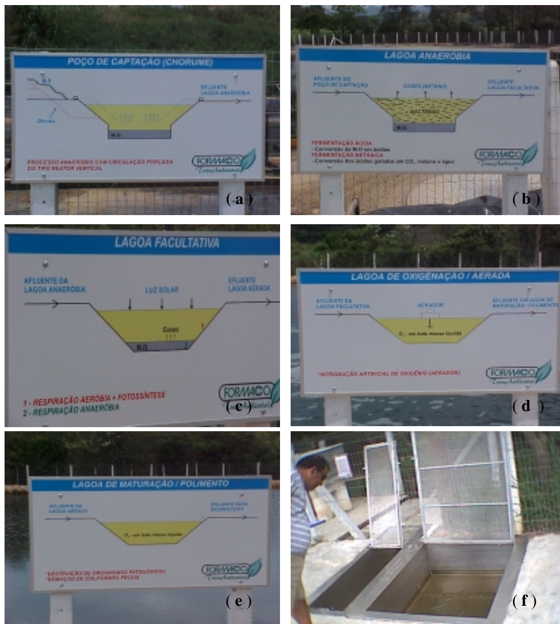
Figura 26. Sistema de tratamento de efluentes do aterro sanitário. (a) poço de recepção; (b) lagoa anaeróbica; (c) lagoa facultativa; (d) lagoa aerada; (e) lagoa de maturação (polimento) e (f) desinfecção.
