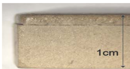
Figura 4.8 – Defeito de interface esmalte/substrato
