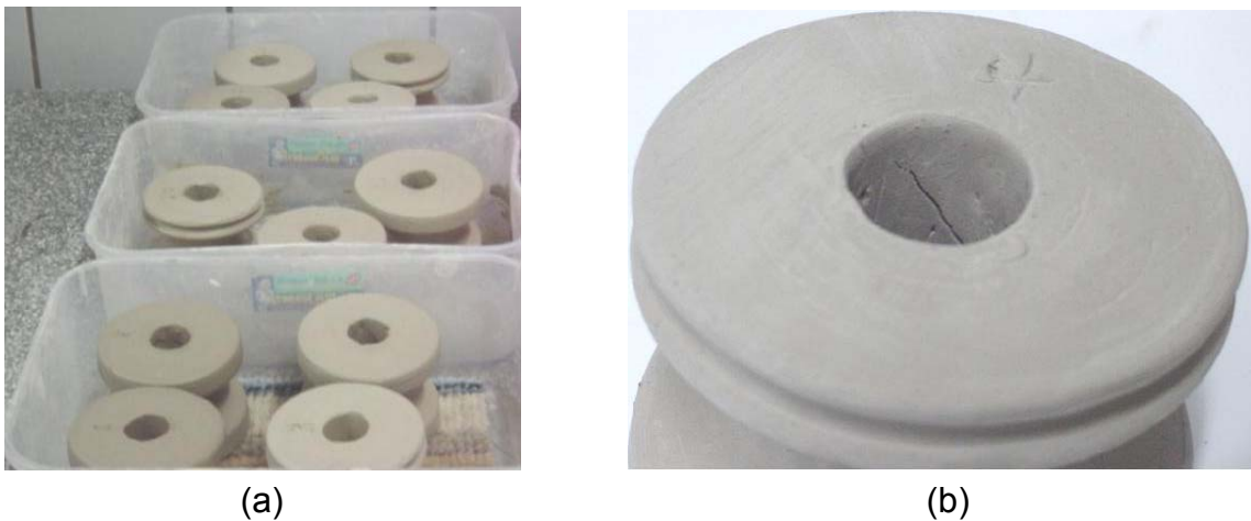
Figura 4.19 – (a) Secagem das amostras; (b) trinca de secagem
