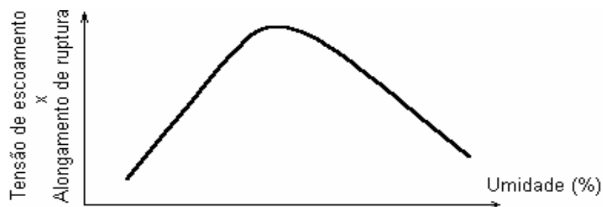
Figura 2.7 – Trabalhabilidade de uma argila em diferentes teores de umidade
