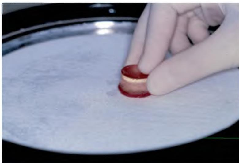
Figura 10 – Polimento dos blocos de esmalte em um disco de feltro montado no prato giratório da politriz, umedecidos com pasta diamantada e água deionizada.
