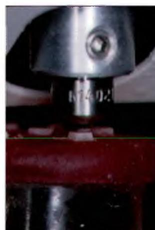
Figura 11B – Vista do endentador Knoop durante a medição da dureza inicial dos blocos de esmalte.
