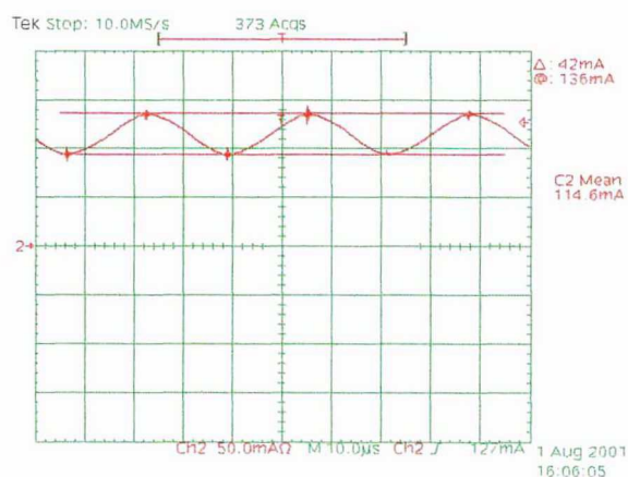
Fig. 3.45 - Ondulação na corrente de entrada.
