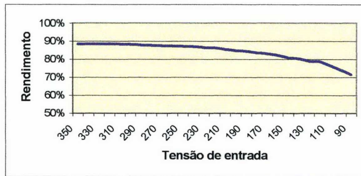
Fig. 3.47 - Gráfico do rendimento em função da tensão de entrada.
