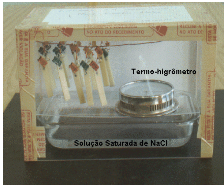
Figura 8: Dispositivo montado para o ensaio de absorção de umidade com ambiente controlado em 80% URE
