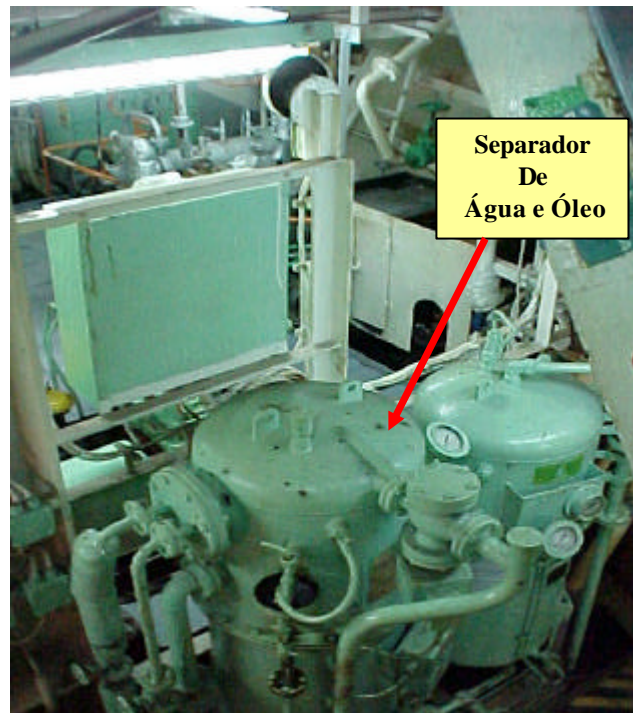
Fig.4.5 – Separador de água e óleo instalado na praça de máquinas de um navio
