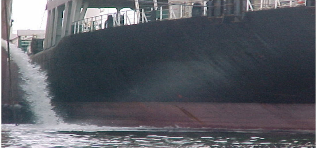
Fig. 4.8 – Navio em deslastro através de descarga alta de costado, no porto.
