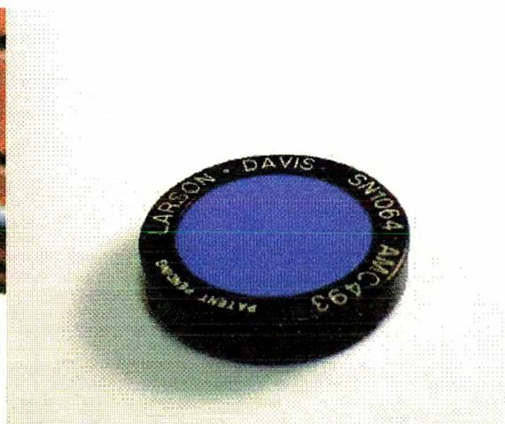
Figura 4.10 - Fotos do acoplador mecânico Larson Davis modelo AMC493 (LARI)
