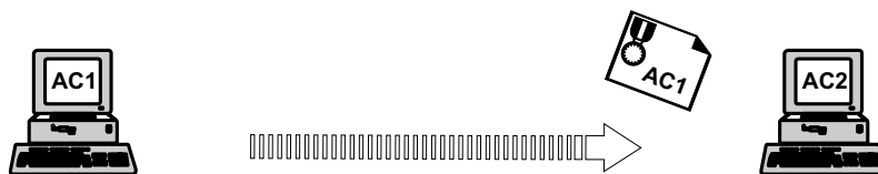
Figura 3.4: Na certificação cruzada unilateral somente um dos lados possui confiança no outro. Na figura acima a AC2 confia na AC1. Esta confiança é atribuída pela assinatura do certificado AC2 pela AC1. Porém a AC1 não confia na AC2, pois esta não assinou seu certificado.
