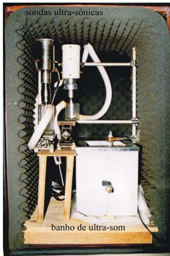
Figura 36: Vista frontal da caixa de isolamento acústico para os experimentos com energia ultra-sônica.
