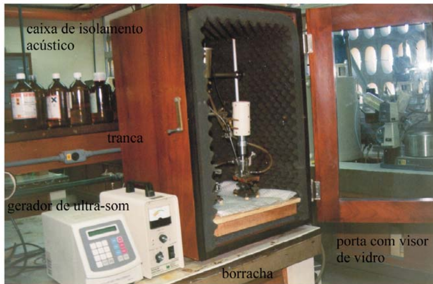
Figura 35: Caixa com isolamento acústico para a realização dos experimentos com energia ultra-sônica.
