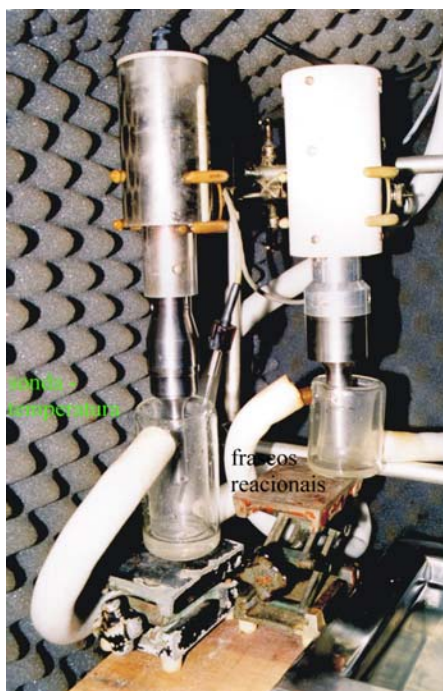
Figura 37: Frascos reacionais utilizados com ultra-som do tipo sonda e com o monitoramento da temperatura reacional.
