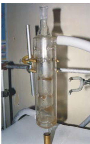
Figura 39: Condensador desenvolvido para a realização de refluxo em microondas.
