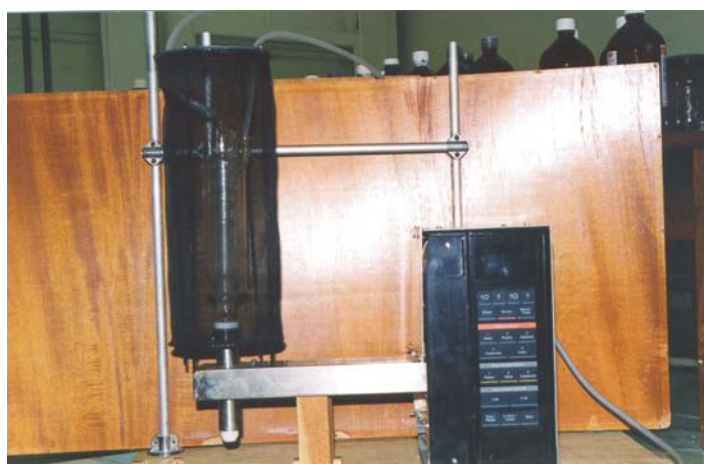
Figura 42: Sistema tipo gaiola, para evitar vazamento de microondas.
