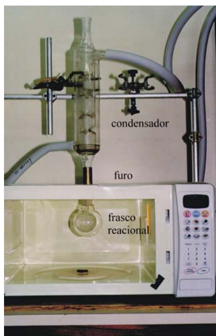
Figura 38: Forno de microondas doméstico adaptado para reações químicas.
