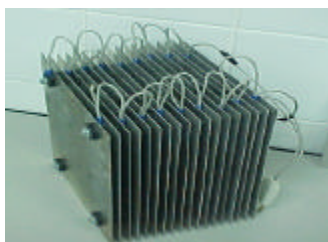
Figura 09 – Foto da Colméia de eletrodos em Alumínio.
