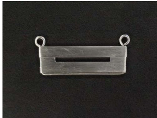
Figura 3A – Molde metálico bipartido utilizado para a confecção dos corpos de prova.
