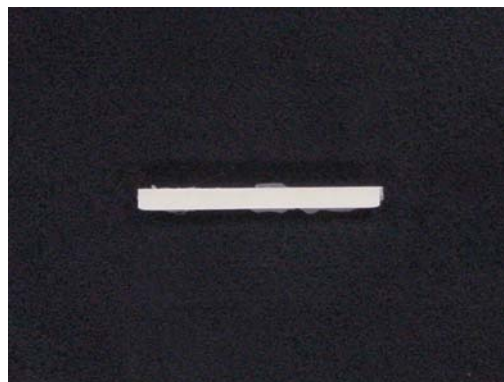
Figura 2F – Corpo de prova recém-retirado do molde e com excessos de cimento.
