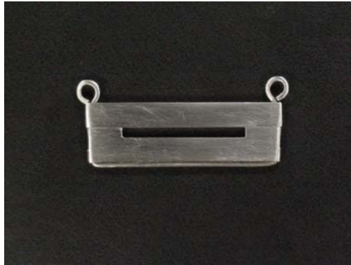
Figura 2A – Molde metálico bipartido utilizado para a confecção dos corpos de prova.
