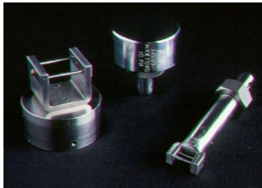
Figura 4 – Peças de teste utilizadas para a realização do teste de resistência flexural.
