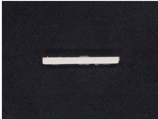
Figura 3F – Corpo de prova recém-retirado do molde e com excessos de cimento.
