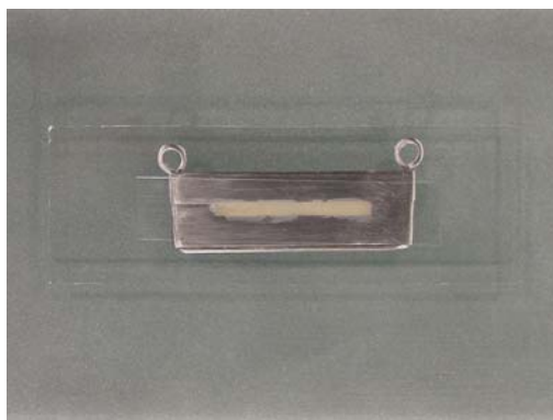
Figura 2D – Recobrimento do molde metálico bipartido com uma segunda tira de poliéster e lâmina de vidro para microscopia.
