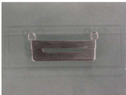
Figura 2B – Molde metálico bipartido posicionado sobre uma placa de vidro, interpostos com uma lâmina de vidro para microscopia e uma tira de poliéster.
