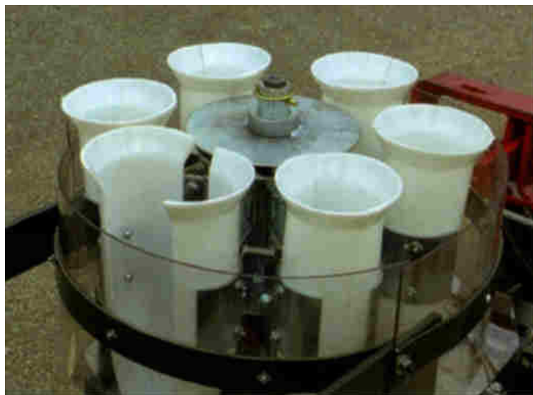
Figura 2.17 - Unidade de Dosagem de Mudas da Transplantadora Holandesa, Modelo Unidade Rotatória
