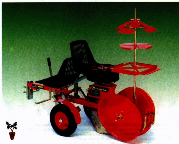
Figura 2.20 - Modelo MINITEX–Característica Principal: Distribuidor Giratório
