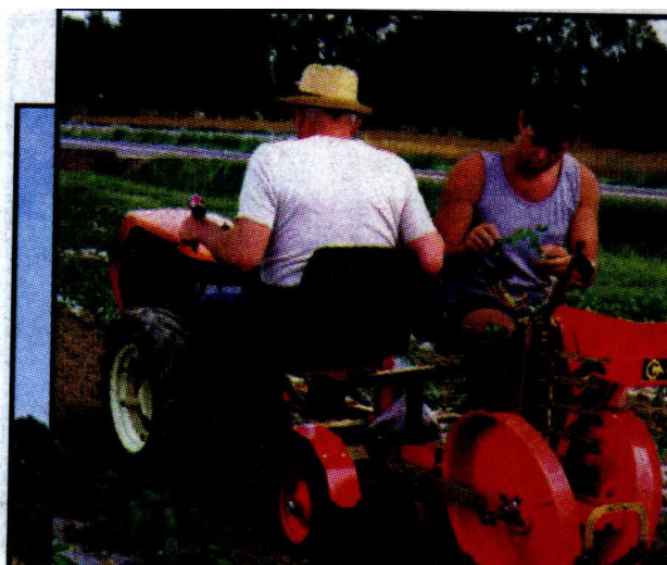
Figura 2.19 - Modelo MINIFOX – Característica Principal: Distribuidor Agarrador
