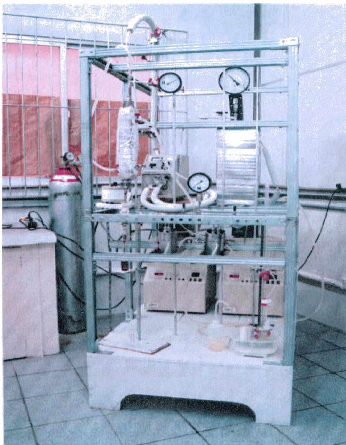
Figura 3.2 Unidade de extração supercrítica – LATESC-UFSC.
