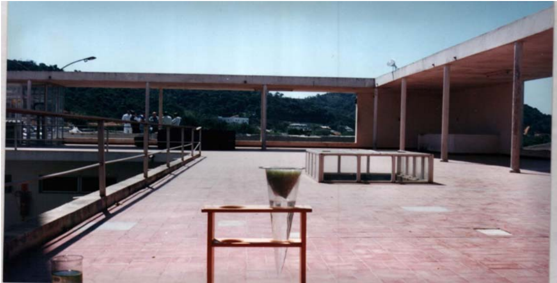
FIGURA 19 – VISTA DE UM CÔNE IMHOFF NO QUAL NA PARTE SUPERIOR ENCONTRA-SE UMA PENEIRA QUE RETEM ALGAS E SOB A MESMA O LÍQUIDO CLARIFICADO).
