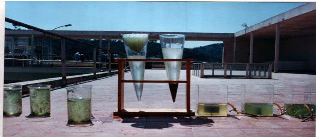
FIGURA 18 – NO CÔNE IMHOFF, A ESQUERDA, NA PARTE SUPERIOR ENCONTRA-SE UMA PENEIRA QUE RETEM ALGAS E SOB A MESMA VERIFICA-SE O LÍQUIDO CLARIFICADO ENQUANTO QUE NO CONE DA DIREITA VERIFICA-SE NO FUNDO “LODO DA ÁGUA DE LAVAGEM DE FILTRO DA ETA” E ACIMA DO MESMO O LÍQUIDO CLARIFICADO.
