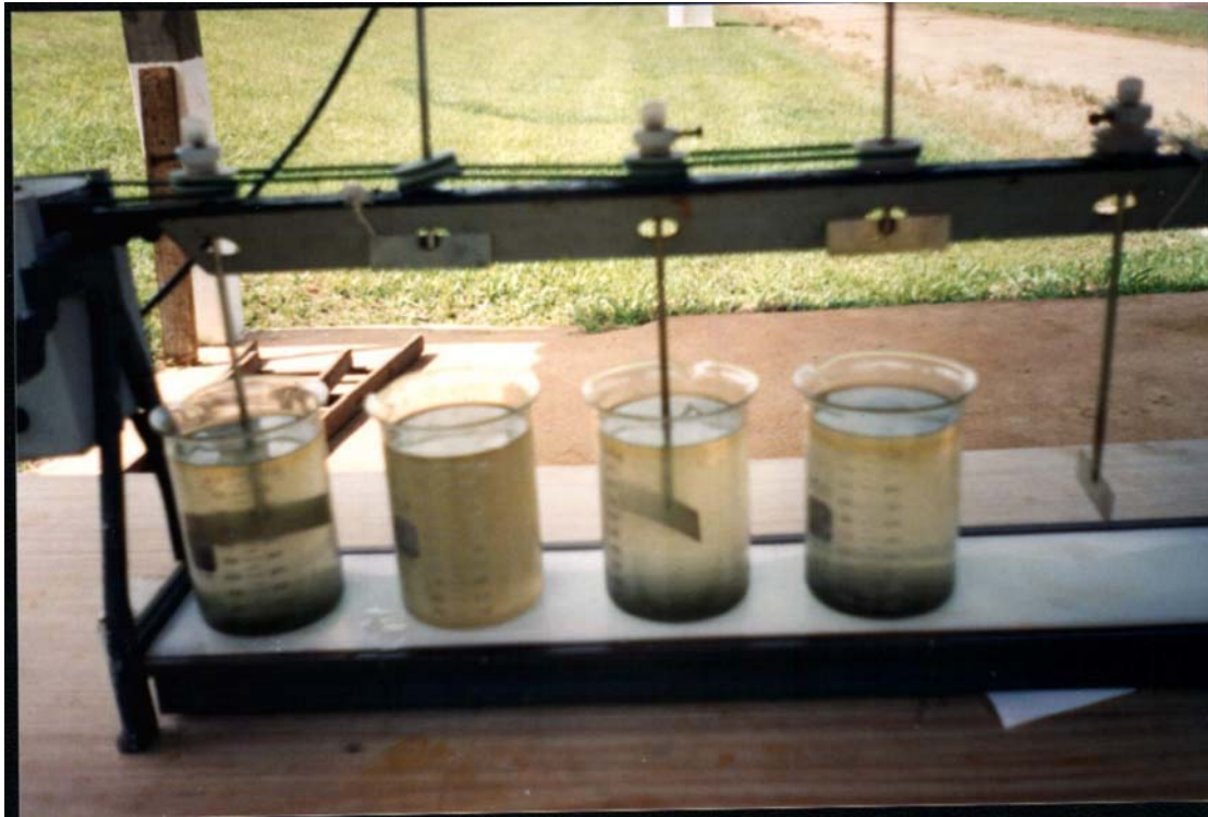
FIGURA 21 – “JAR TEST” REALIZADO EM CAMPO COM DOSAGEM DE CLORETO FÉRRICO COM DOSAGEM DE SOLUÇÃO DE CLORETO FÉRRICO NOS EFLUENTES DAS (LA-1 E LA-2).
