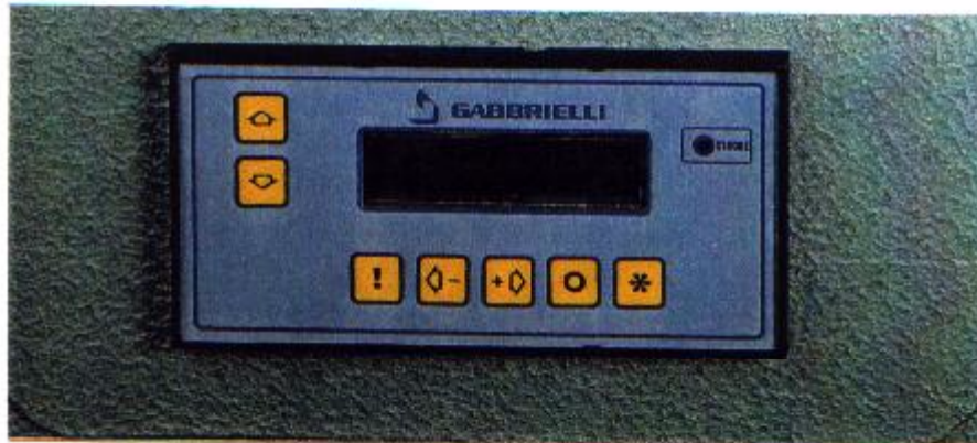
Figura 16: Mostrador digital do flexômetro “Gabrielli”, modelo CRAB-424
