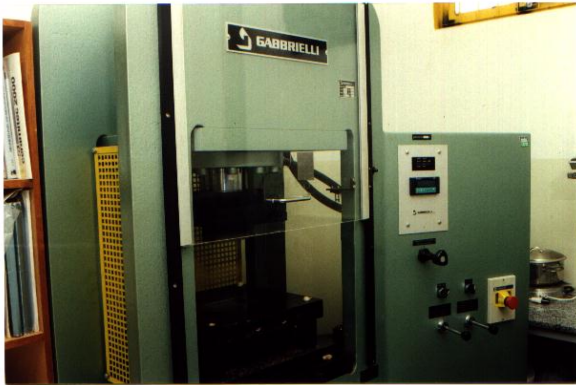
Figura 11: Prensa hidráulica “Gabrielli”, modelo L4/110
