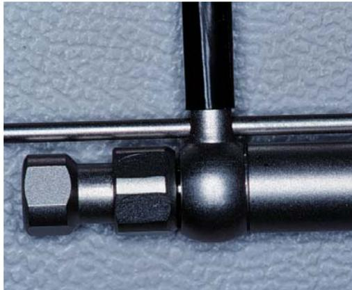
Figura 13B– Limitador de torque.
