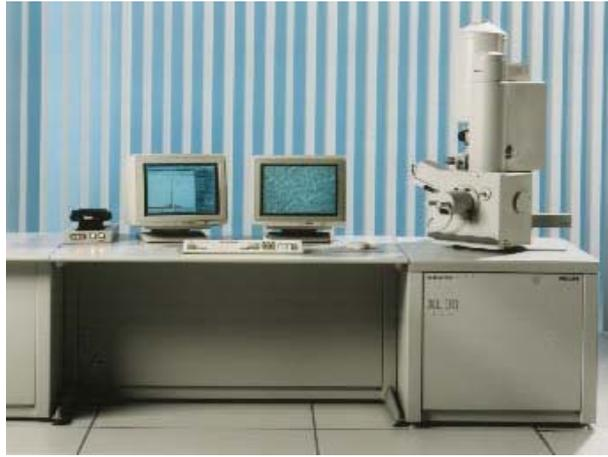
Figura 11 - Microscópio eletrônico de varredura.
